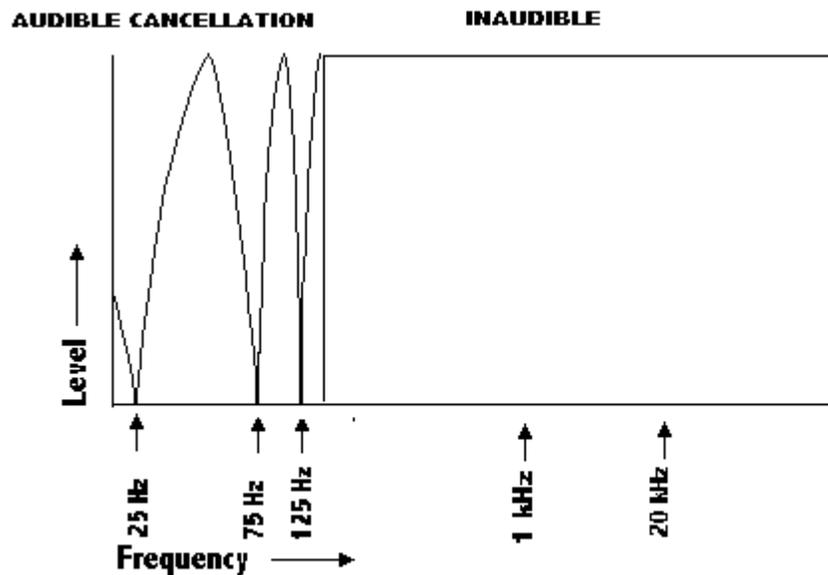
**FIGURE 13 - FREQUENCIES CANCELING WITH 20 MS DELAY BETWEEN MICS**
