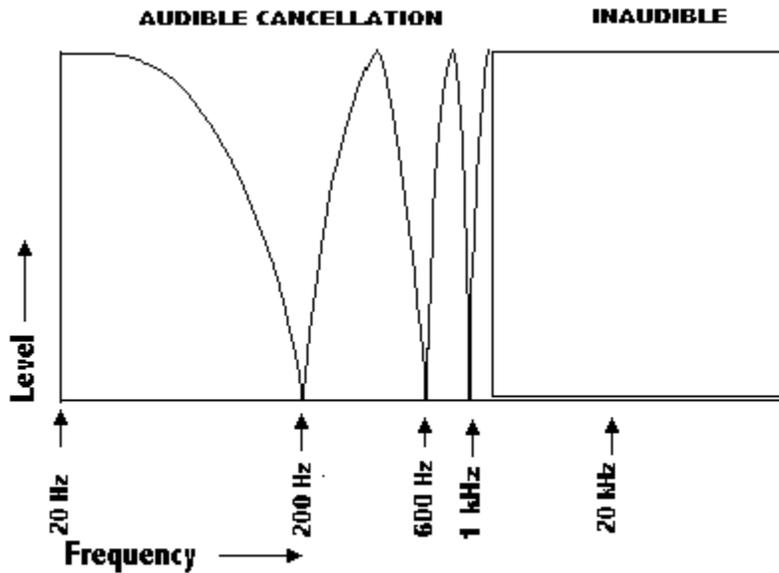
**FIGURE 12 - FREQUENCIES CANCELING WITH 2.5 MS DELAY BETWEEN MICS**
